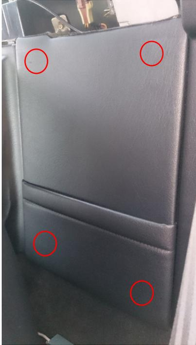
赤丸部分(4箇所)がクリップで止まっているので、車両前方側に引き出して取り外します。
